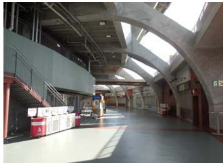
F 球場内を1周するコンコース (3階) 平坦で十分な幅(内野12m、外野8m)のコンコース沿いに、飲食売店、多機能便房、車いす使用者用観覧席等が設けられている。
